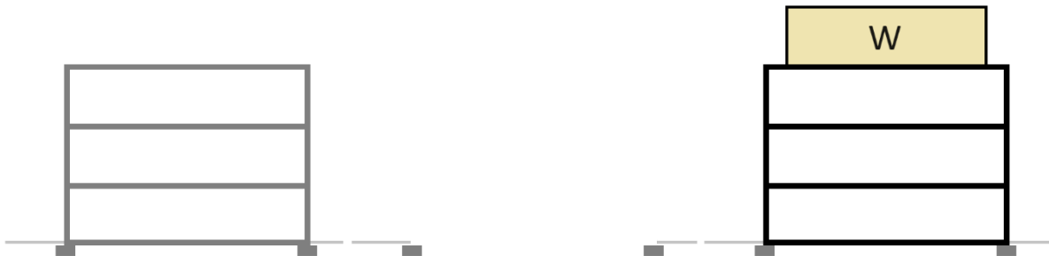
Figuur 5 – Een bestaand bouwwerk (links) slopen tot op de fundering (midden), weer opbouwen en vervolgens optoppen (rechts) is geen ‘verbouw’ maar ‘herbouw’.
