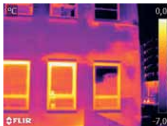
Situatie 5: Aanzicht metselwerk met vochtige plekken. Daarbij lijken bovendorpels warmtelekken te zijn maar dit blijken enkel reflecties van tegenovergelegen gebouwen te zijn.
