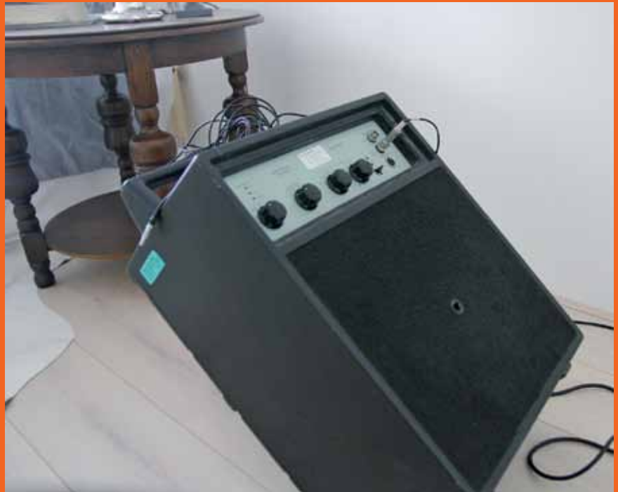
De galmtijd bepalen van de verblijfruimtes kan met een grote geluidsbron die een zogenoemde roze ruis van 100 dB produceert.
