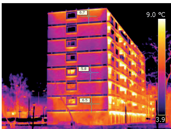
Figuur A 7210-2 Thermografische opname van een gevel: de meeste energie uit de woningen gaat verloren via de gevelopeningen
