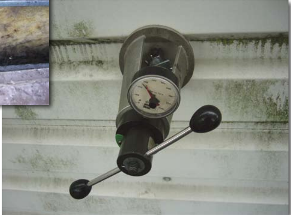
Middels uittrekproeven is de kwaliteit van meer dan 20 jaar oude bevestigingsmiddelen beoordeeld. De resultaten hiervan waren zondermeer positief.
